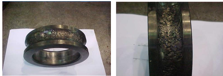
Obs.: Fotos cedidas por um cliente que teve problemas com correntes nos rolamentos usando inversores de 2 níveis.
