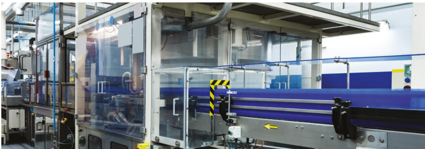
Uma função padrão do GA800 é o Safe Torque Off, que previne produção de torque ao motor mesmo com a máquina ligada. Isso minimiza o tempo de parada quando pessoas adentram a zona de segurança.
